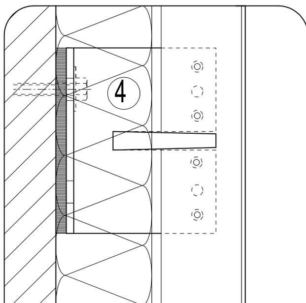
**c** Percage pour les trous des rivets
